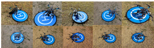
그림 9. 객체 인식 기반 자동 착륙 Fig. 9. Auto Land base on object detection
