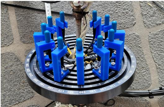
그림 8. 제작된 원형 배열 하이드로폰 구조물
